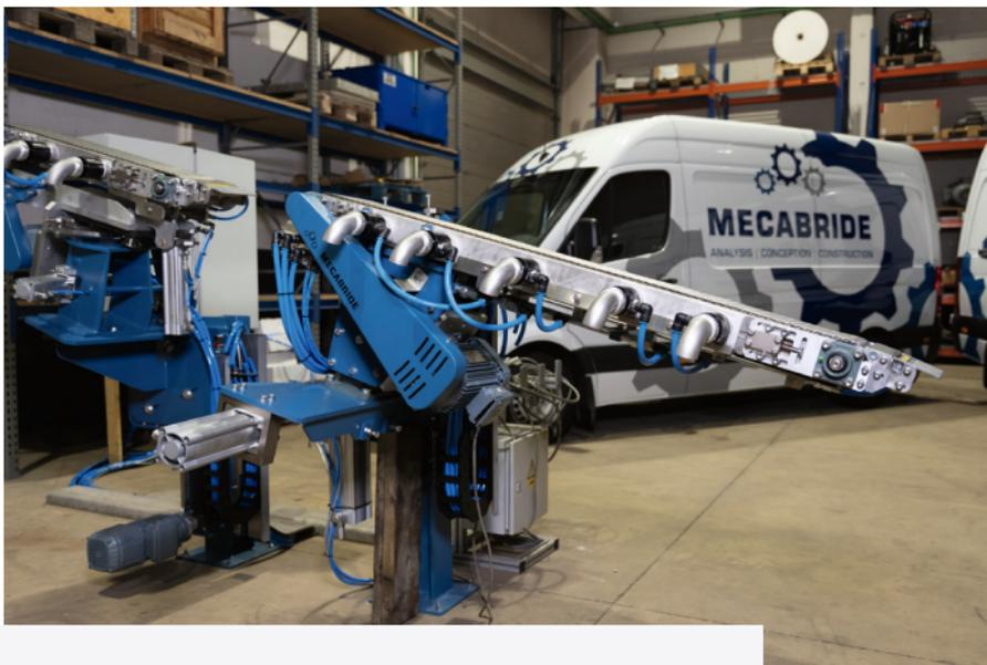
Convoyeur à bande sous vide, rampes d'air et systèmes de coupe pour un passage de pointe automatisé sans cordes dans la machine à papier
