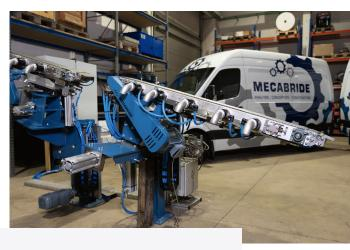
Vakuumförderer, Luftrampen sowie Schneidesysteme zur automatischen, seillosen Streifenüberführung in der Papiermaschine
